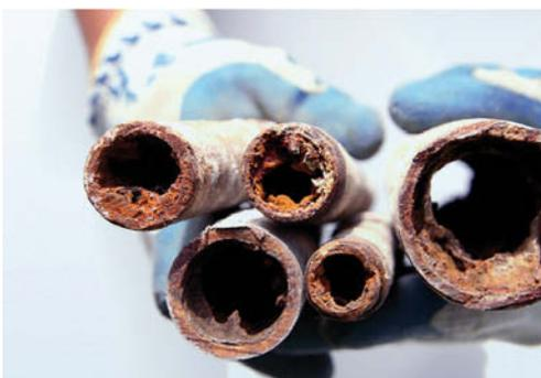
Über Jahrzehnte mit Kalk und Rost zugesetzte Rohre
