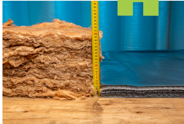
Im Schnitt 11 Prozent weniger Heizenergie: Im Vergleich liegt die nur 2,5 cm starke reflektierende Dämmfolie vor der 20 cm starken Mineralwolle.
